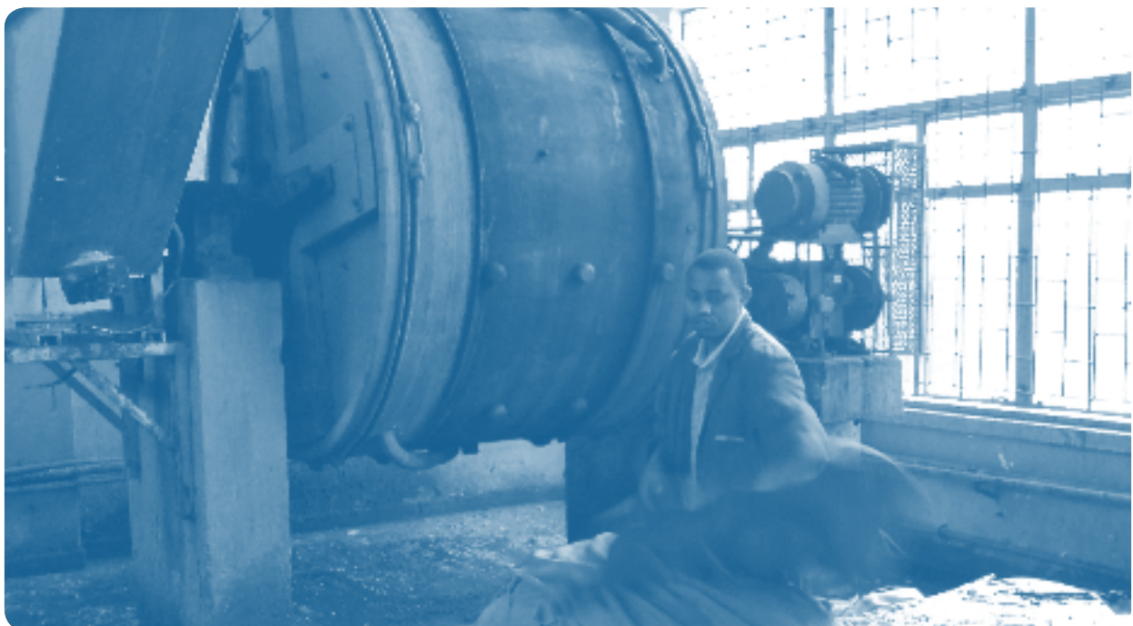
Gerbfass und Arbeiter im Zentrum für Lederentwicklung, Nairobi: Teil des Verarbeitungsprozesses von Fellen und Häuten zu Leder. © Foto: Mark Curtis.
